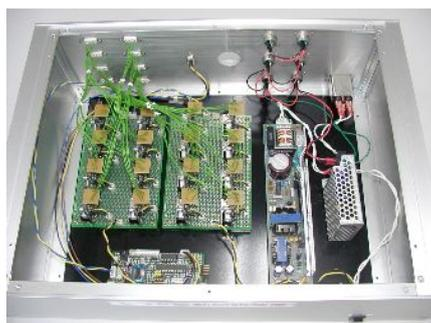
図3 センサ駆動回路部写真
