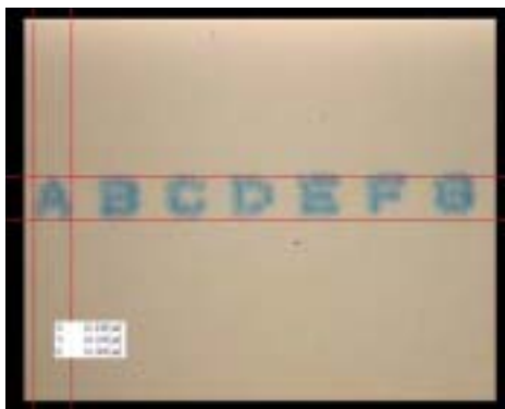
写真 1-1-4 PET 製平板への 20 μm の文字 (青色)
