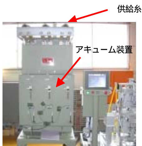
写真 3-1-1 糸送り装置 送り出し部
