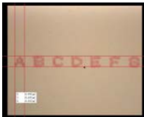
写真 1-1-5 PET 製平板への 20 μm の文字 (赤色)
