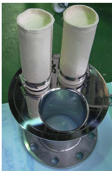
図 4-21 ゴアテックス#5724で 製作したフィルター
