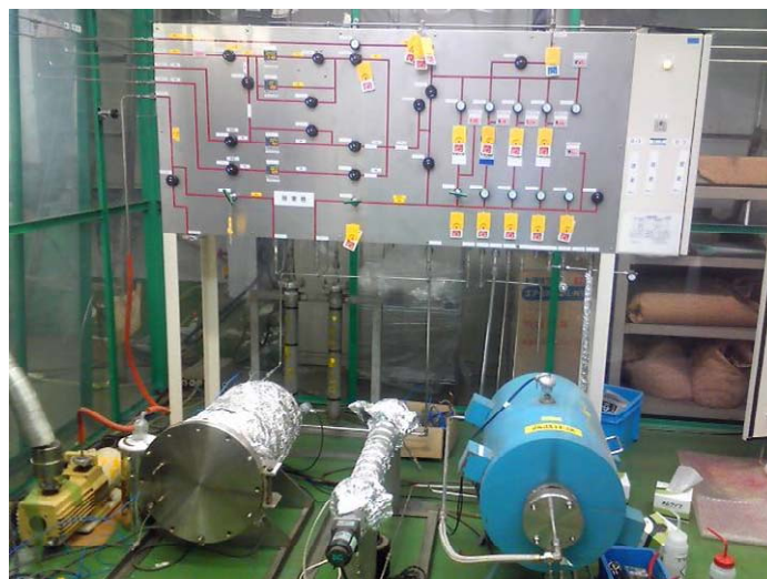
図 2-2 小型バッチ式フッ素処理装置
