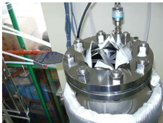
図 4-18 約220kPaで破裂したラプチャーディスク
