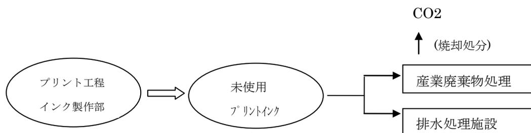
図 1.1.1 従来の未使用プリントインク処理方法
