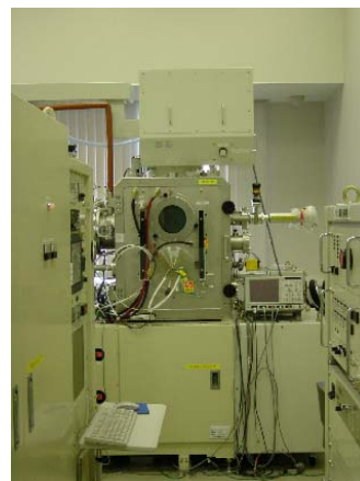
図 4 プラズマイオン注入装置（PBII）
