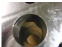
図 24 未処理刃物での加工穴
