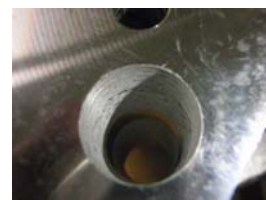
図 25 処理刃物 (切削条件 30%UP) での加工穴
