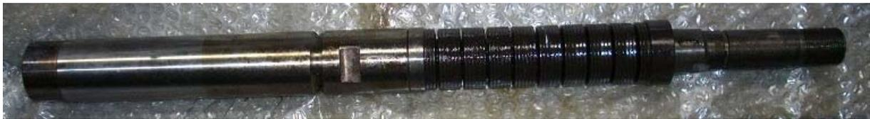
図 8 皿ばねを組み込んだスピンドルユニット
