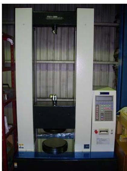
図4 皿ばね試験装置
