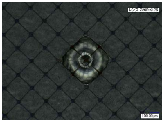
図4-1. 銅の格子状フィルム電極シート
