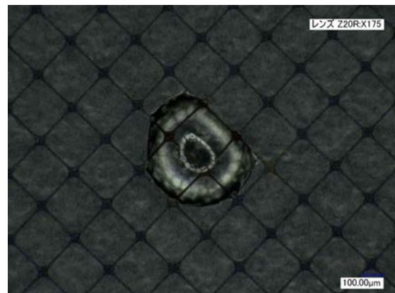
図4-1. 銅の格子状フィルム電極シート
