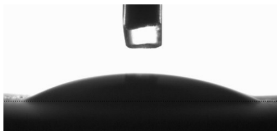
図4：ノーマルノズル（接触角：25.3°）
