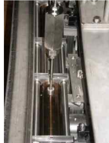
図 29 循環ポンプ((a); 全体図、(b); 外筒部、(c); ポンプ、(d)シリンダ)
