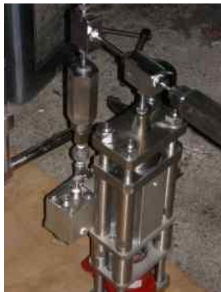
図 32 手動ポンプ((a);全体図、(b);駆動部分)
