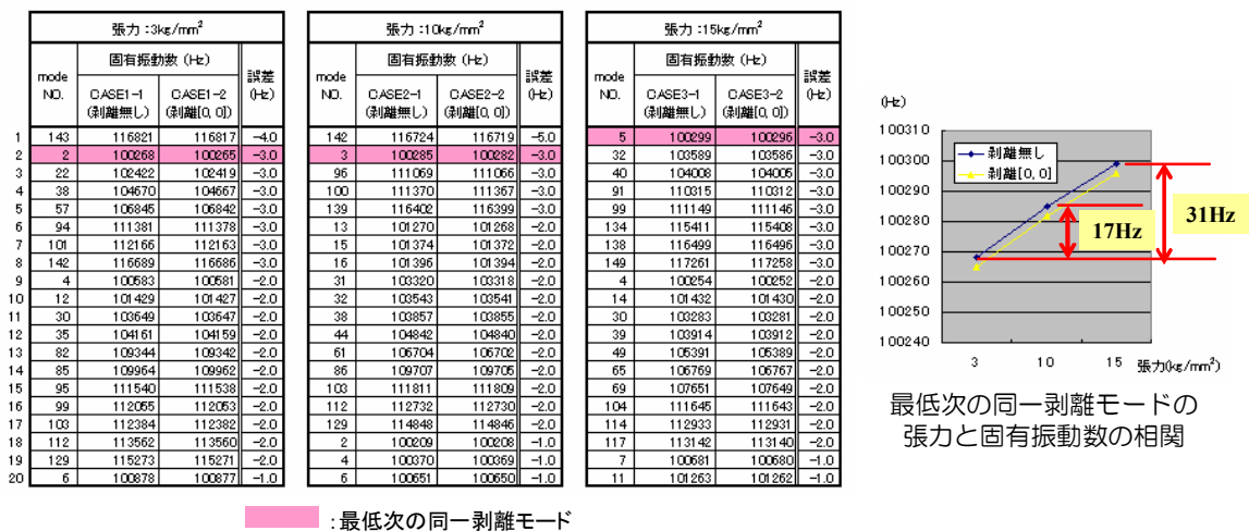
図 13-1 張力と剥離が固有振動に与える影響
