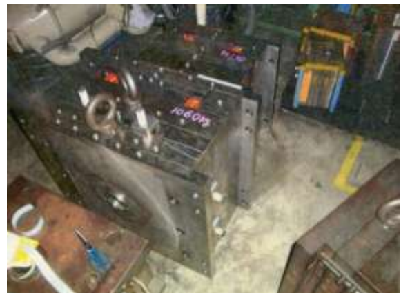
写真 4 300mm ウエハー用グリップリング金型
