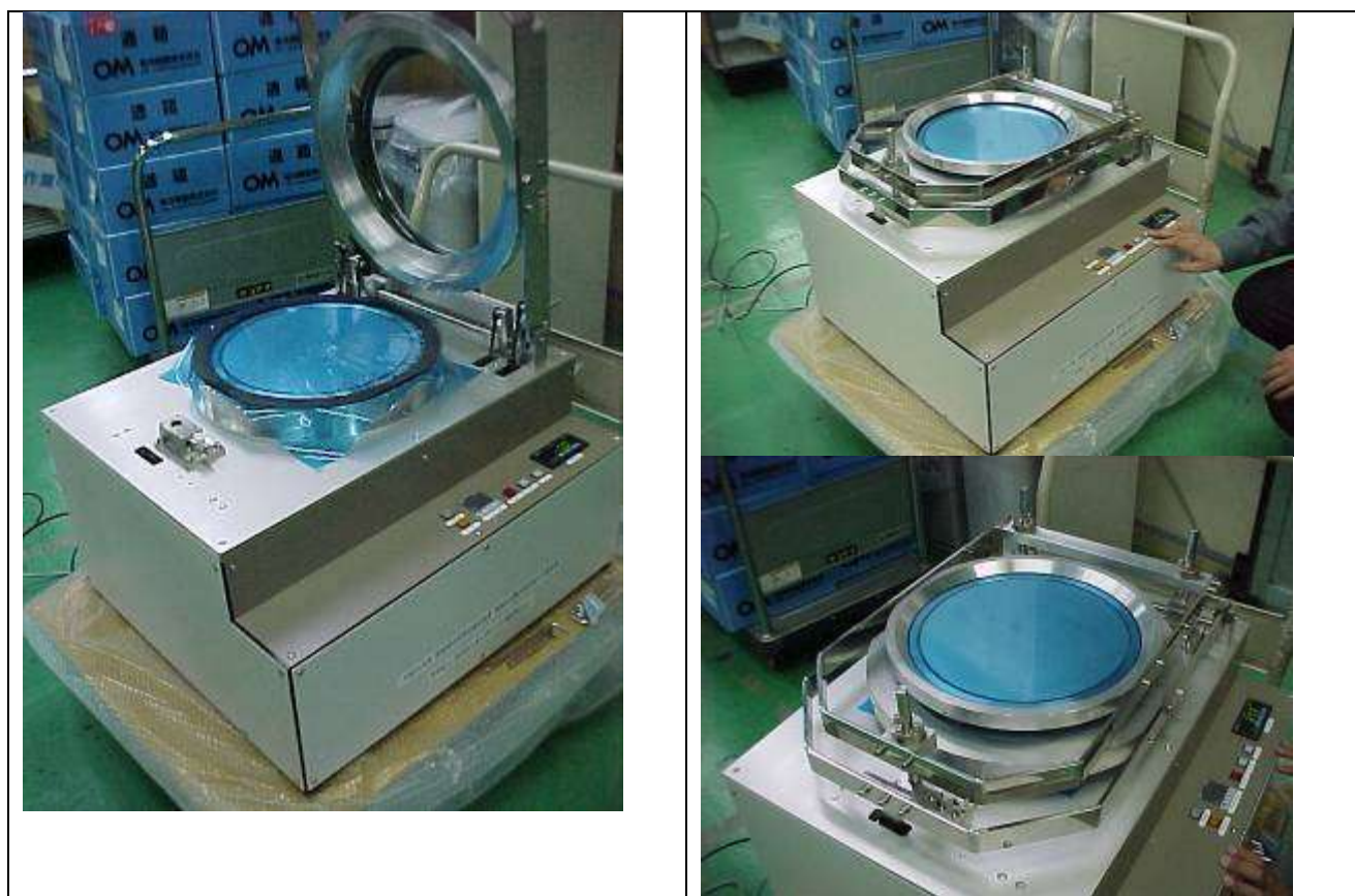
写真 10 300mm ウエハー用グリップリングへのフィルムの張り合わせ
