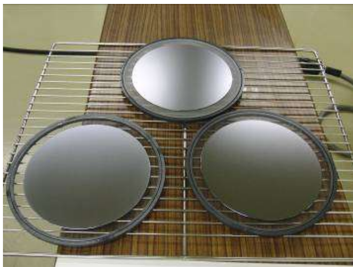
写真 9 耐熱試験後のフィルム張り合わせの状態
