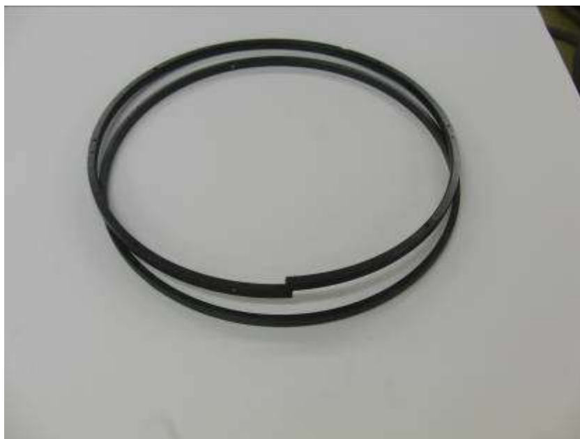
写真 8 破損したグリップリング
