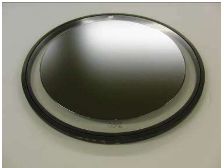
写真 7 フィルム張り合わせ後、200mm ウエハーを張り合わせ
