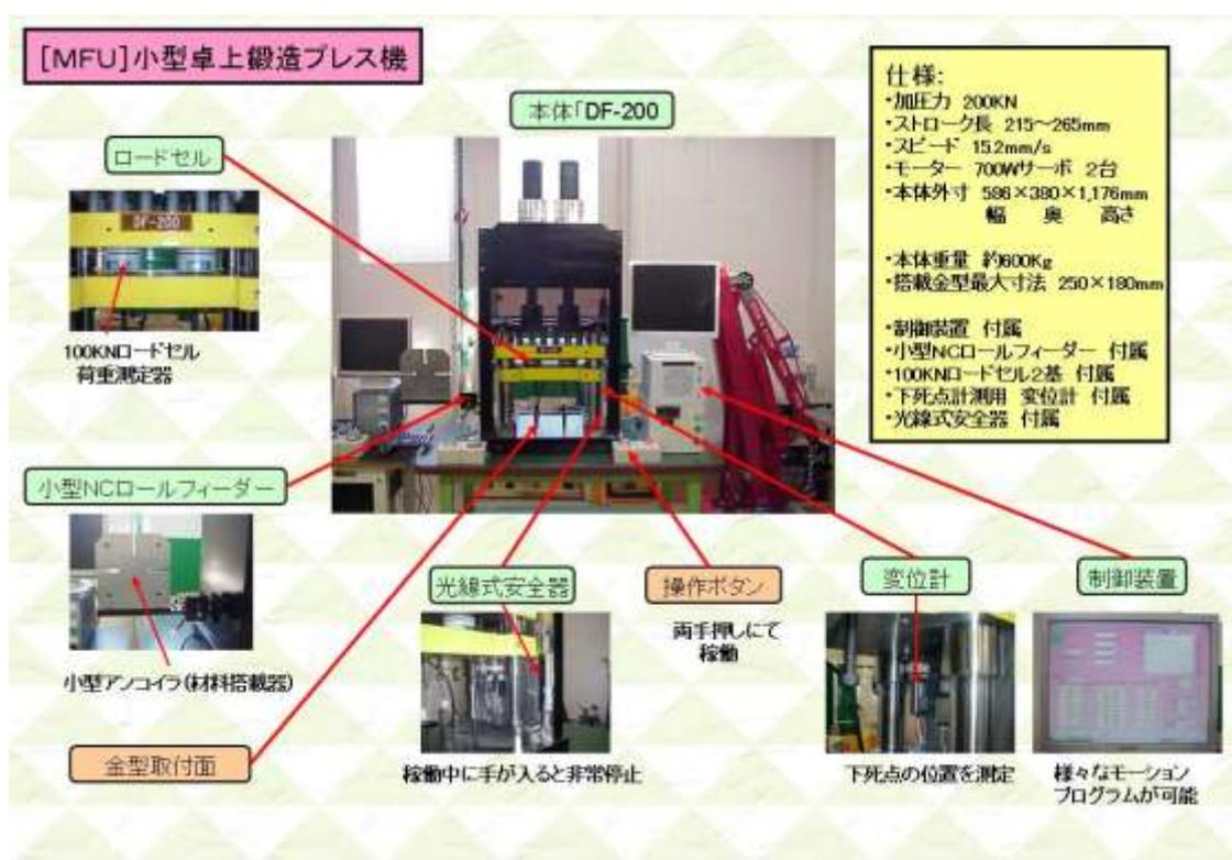
図 3.2.2 プレス機のイメージ写真、主な仕様及び主要部分の拡大図
