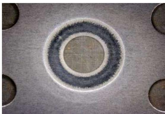
図 3.3.2 鍛造後の Ti 表面性状写真
