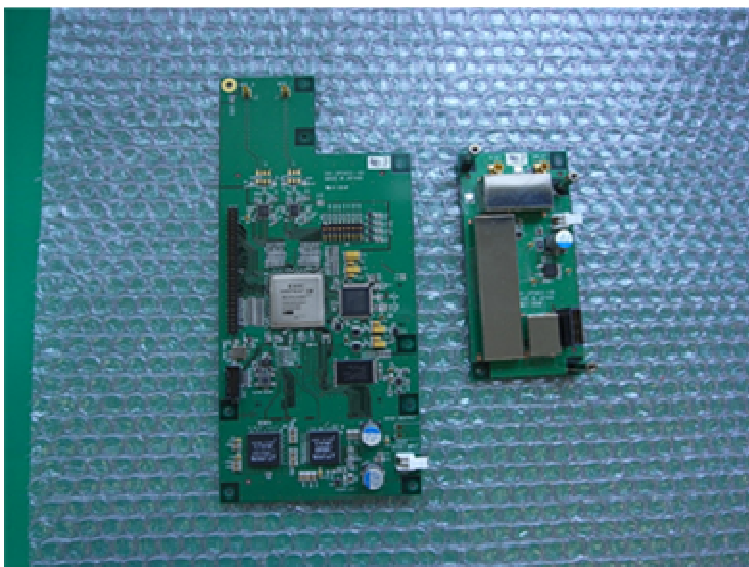
図 2-6 変調部（デジタルボード・左／アナログボード・右）
