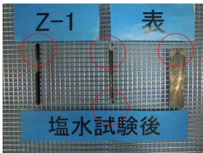
図 2-4-1. 塩水試験後の Z-1 試料外観写真
