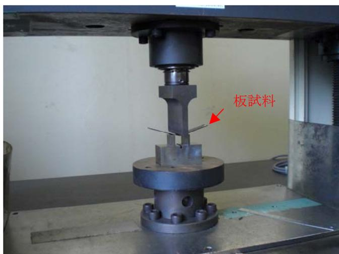
図 2-4-2. 板試料の曲げ試験状況写真
