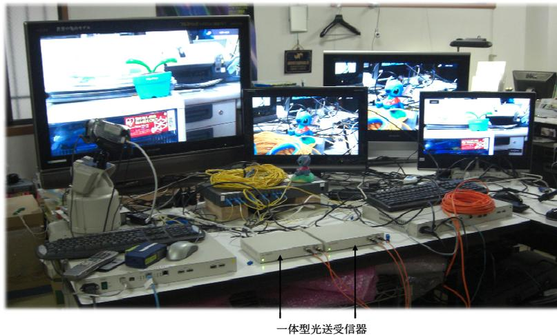
図 11 光送信器と光受信器を一体化した光ハイビジョントランシーバ
