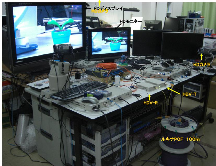
図9 試作ハイビジョン光送受信器によるHDカメラ画像の光送信実験
