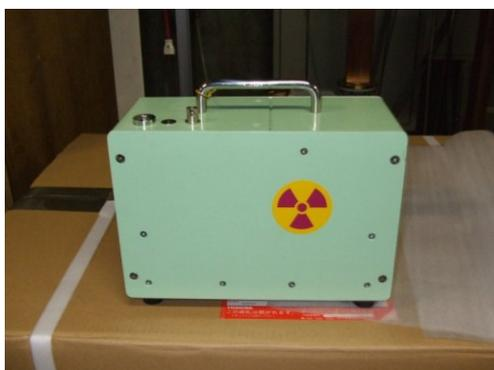
図2-2-8. CNX-X線管と電源をケースに入れた可搬型X線源
