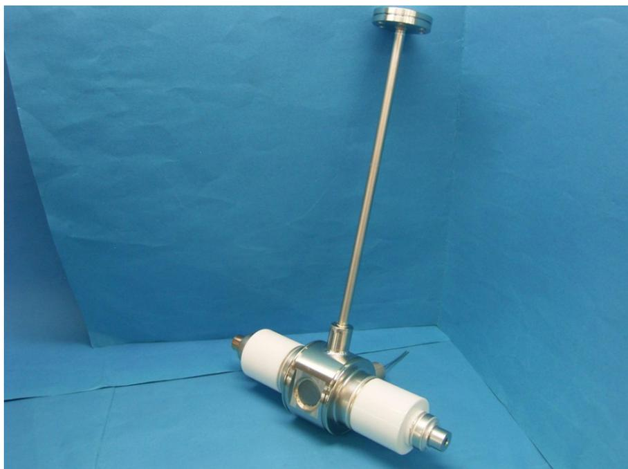
写真2-5-1. 試作X線管
