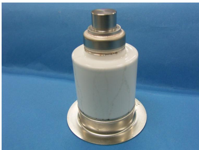
写真2-5-4. 釉薬破壊写真
