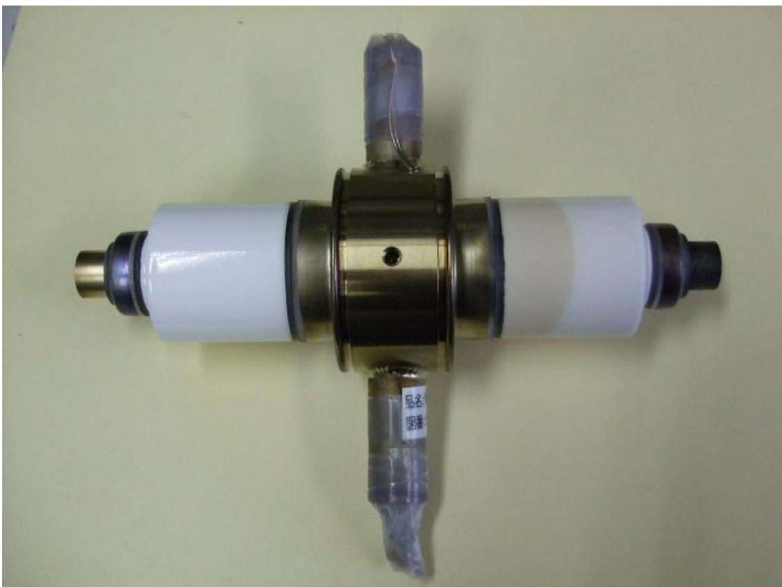
図 2 - 4 - 2 . 寿命試験後の CN X - X 線管
