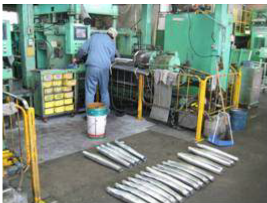
図 2-2-18 ハイドロ成形作業
