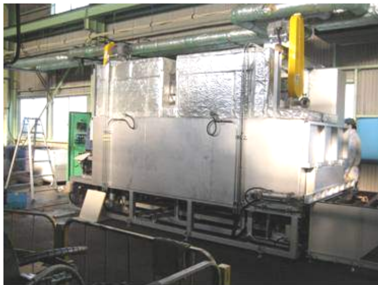
図 2-2-11 導入した急速加熱アルミ熱処理装置
