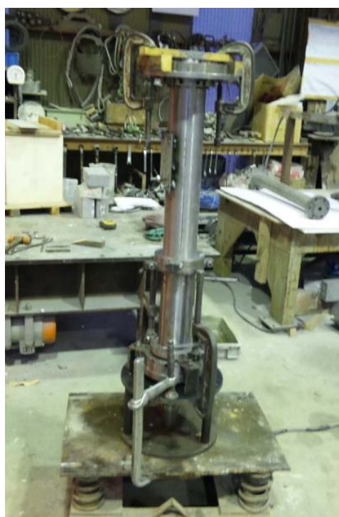
図 7-2 インペラー鋳込み成形
