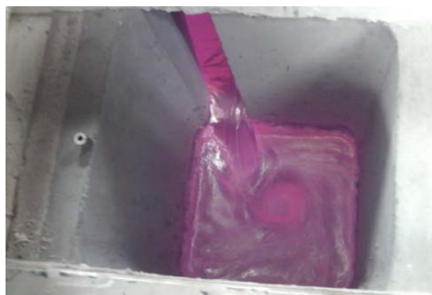
図 4 渦流室のアルミ溶湯の渦の状態
