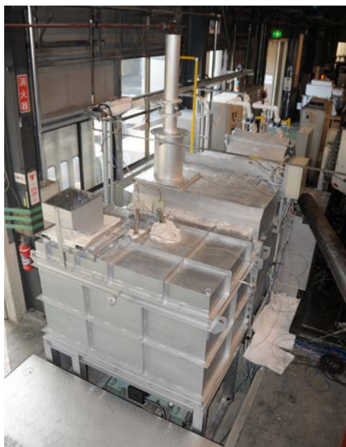
図 12-1 高純度アルミニウム溶湯 給装置（投入室側）
