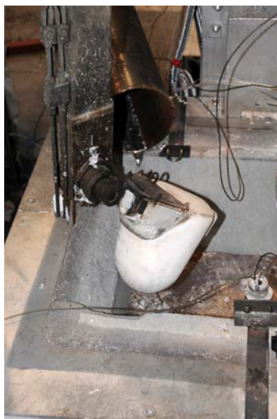
図 13-1 ラドルによる溶湯の汲出し
