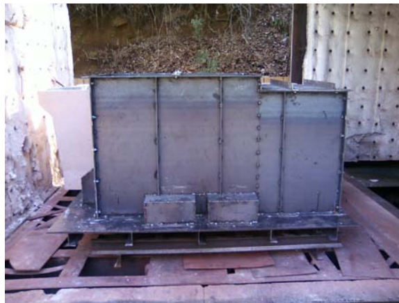
図 5-6 鑄込み後養生炉へ挿入
