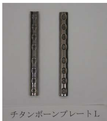
図 2-4-1-2 ボーンプレート L 鍛造後
