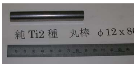
図 2-5-1 ステム(棒)冷間鍛造前
