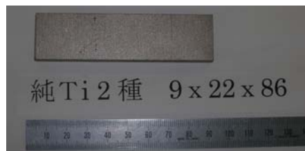
図 2-4-3-1 ステム 素材(板)
