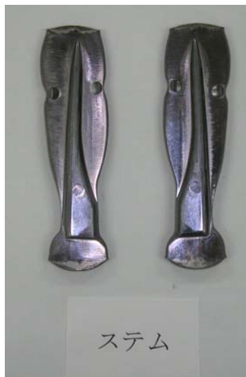
図 2-4-4-2 ステム(丸棒)の鍛造後
