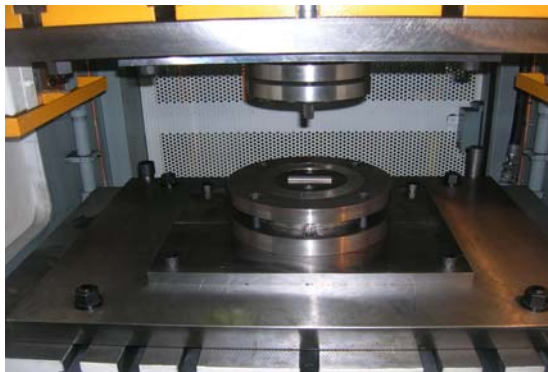
図 2-4-5-2 サーボプレス金型部
