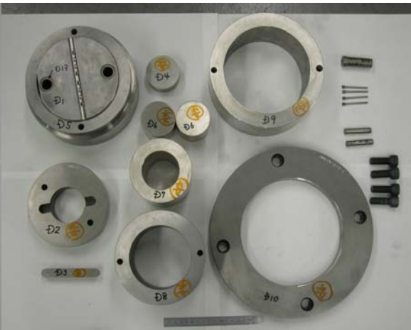
図 2-3-1-2 ボーンプレート L 下型パーツ
