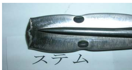
図 2-5-2 ステム(棒)冷間鍛造後
