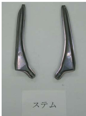
図 2-4-3-2 ステム 鍛造後
