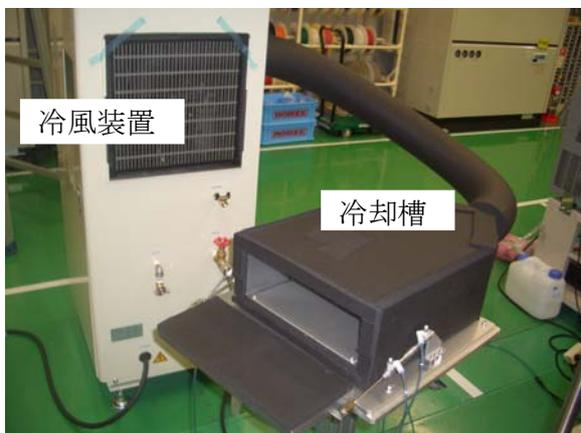
図 2-2-5-1 冷風発生装置と冷却槽
