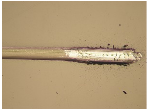
(5) ナノメタル改良材 2 + Ti 単層 200nm + 上層 DLC (左 : 加熱前 右 : 加熱後)
