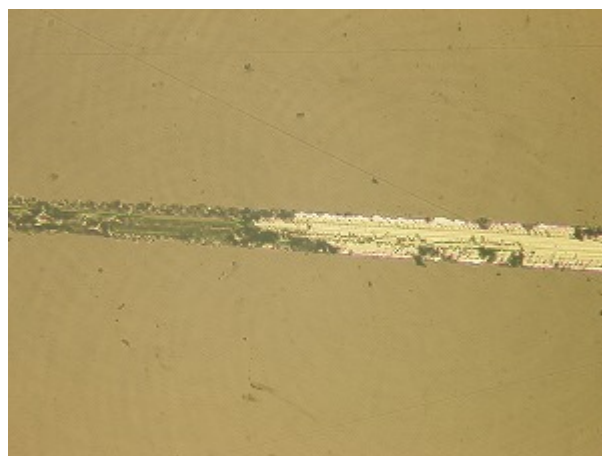
(1) ナノメタル改良材 2 + W 単層 50nm + 上層 DLC (左：加熱前 右：加熱後)
