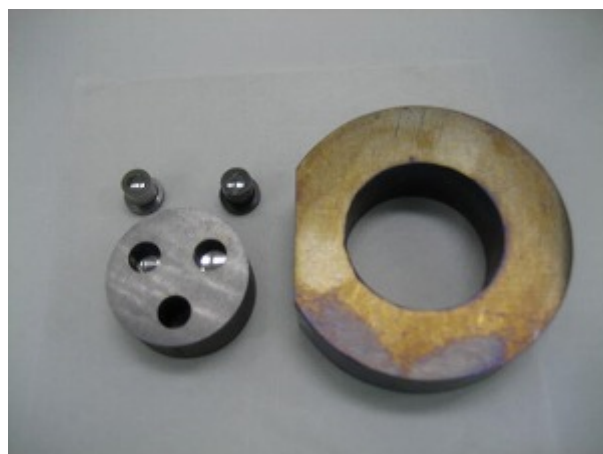
図 4.4 成形テスト時の金型セット
