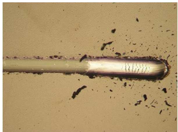
(6) ナノメタル改良材 2 + Si 単層 200nm + 上層 DLC (左 : 加熱前 右 : 加熱後)
