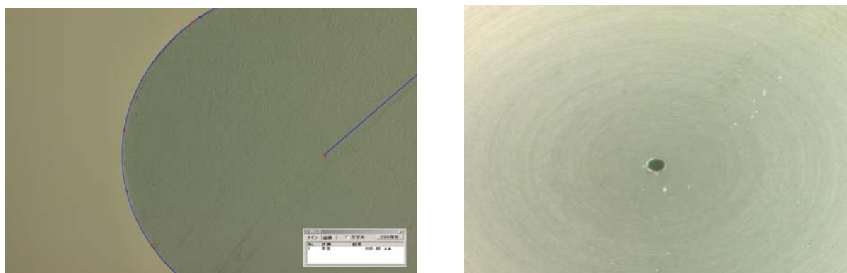
図 3.2 左はバインダレス cBN 右は切削面
