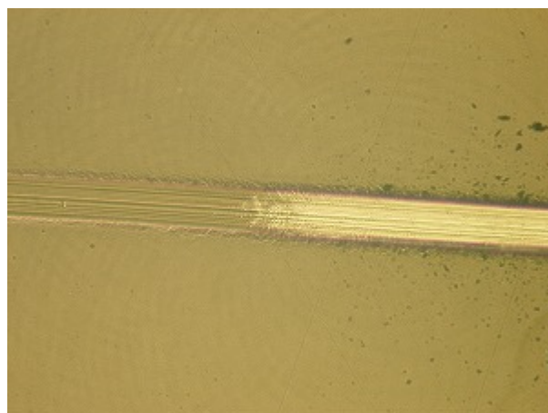
(2) ナノメタル改良材 2 + W 単層 200nm + 上層 DLC (左：加熱前 右：加熱後)
