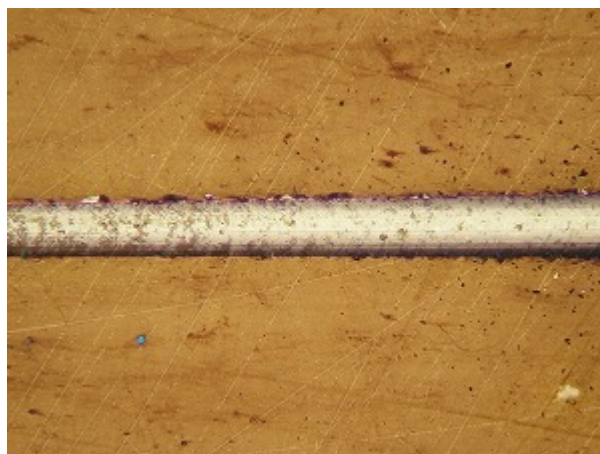
図 2.20 スクラッチ剥離状況写真
