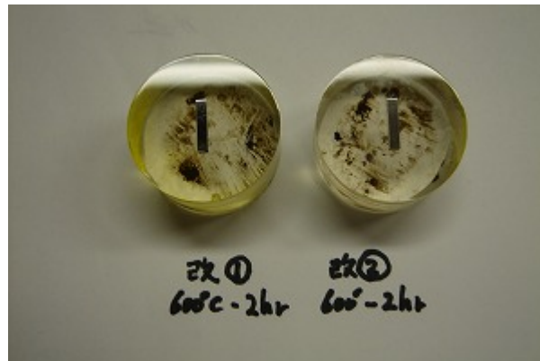
図 2.9 窒化プレ試験用試験片(硬さ用・窒化後)
