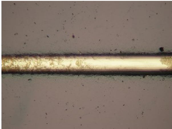
(4) ナノメタル改良材 2 + Cr 単層 200nm + 上層 DLC (左 : 加熱前 右 : 加熱後)
