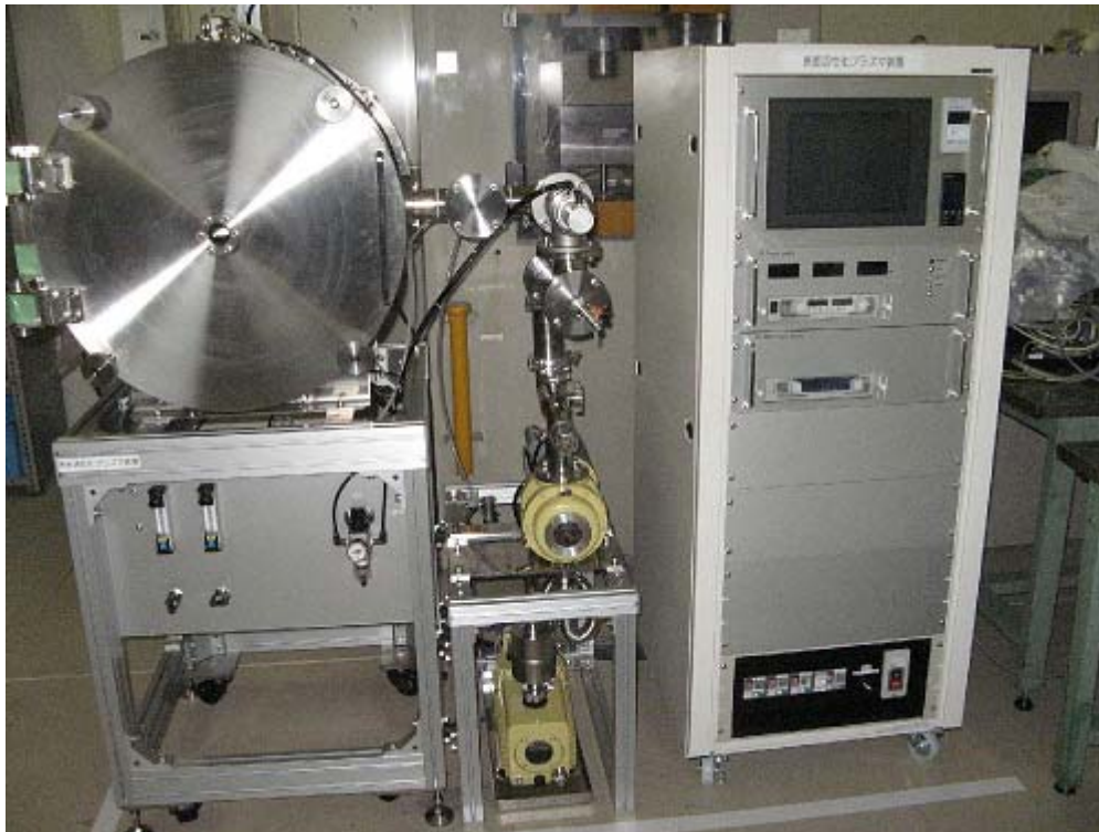
図 2.3 設計開発した高密度プラズマ装置の外観
