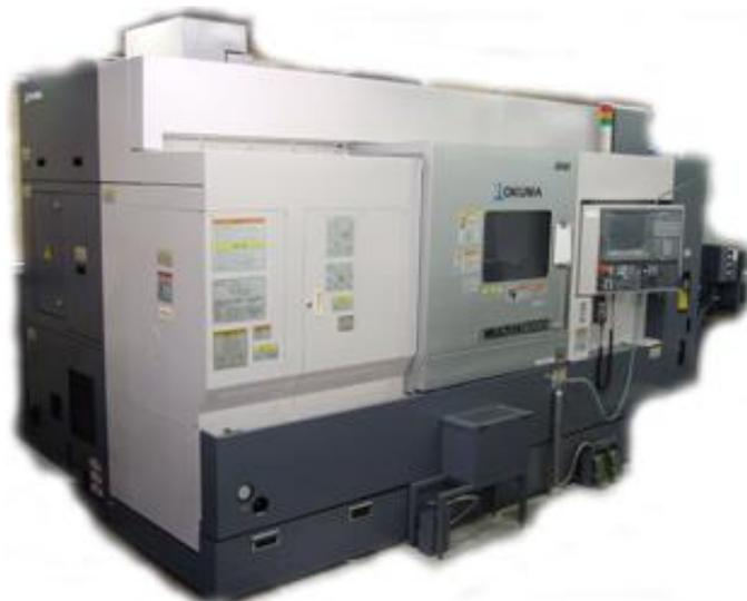
図2 切削加工機 オークマ製複合旋盤
