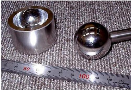
図4 先行切削・研磨加工のボール(右)とカップ(左)の外観
