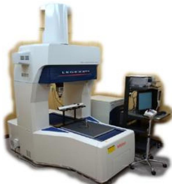
図3 三次元測定機 ミットヨ製三次元測定機
