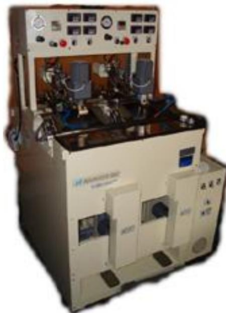
図13：研磨加工機 斜軸型精密研磨機
