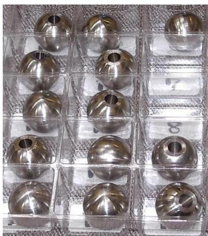
図 7 32mm骨頭の切削加工の量産試作品の外観
