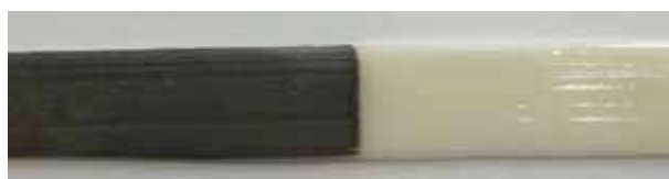
図18 めっきした金属錯体添加シート (左側着色部分)
