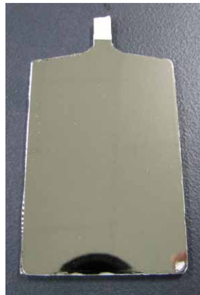
図 3 3 インサート成形/NiP/Ag めっき試作品
