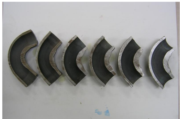
図 3.2.6 曲げ管の断面写真
