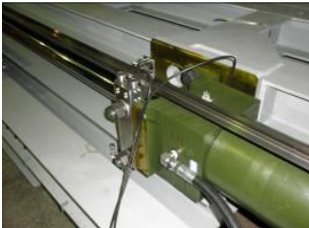
図 2.4.6 油圧シリンダとセンサの取付状態
