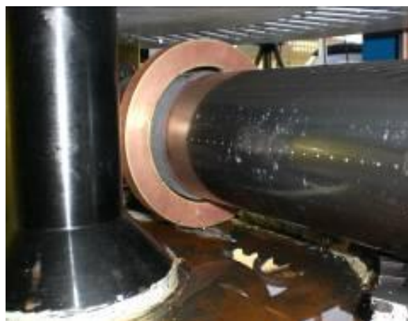
図 2.4.14 加熱コイルの設置状態
