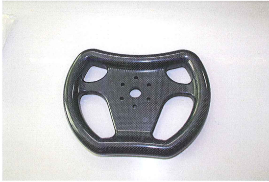
図3-3 レーザアブレーション加工で高精度穴加工された自動車ハンドル
