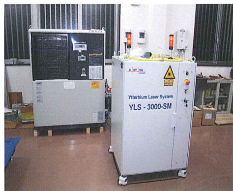
図2-1-6 日本初の3kW SMファイバーレーザー装置
