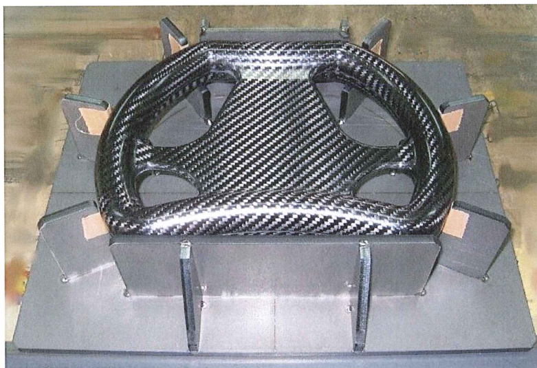
図2-4-12、ハンドル穴あけ加工用取付治具の製作
