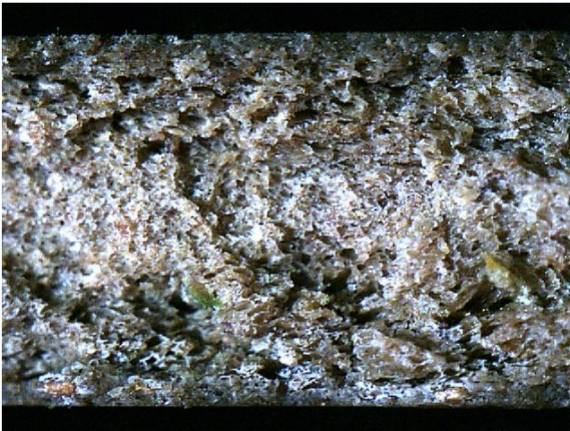
6. 5と同じ条件でコアバック - コアプッシュ 制御を行った場合 (中心部のセルが微細)
