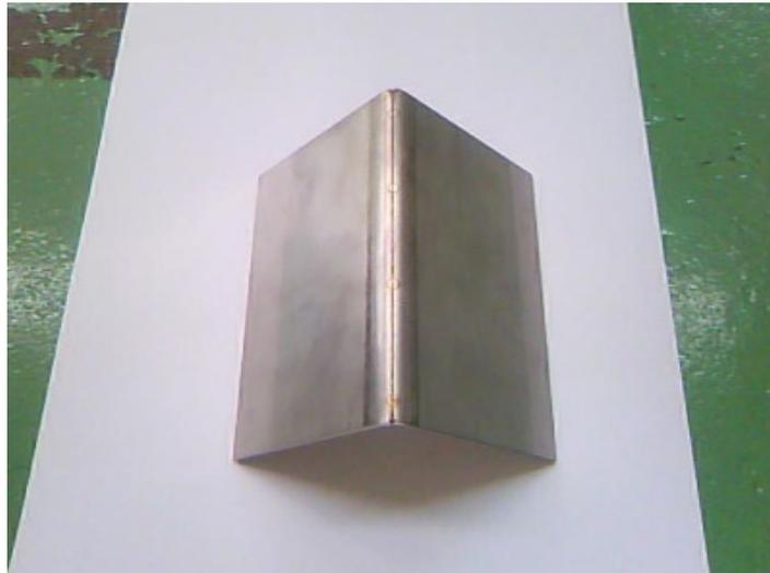
図 7 溶接後 90 度曲げした I 型継手
