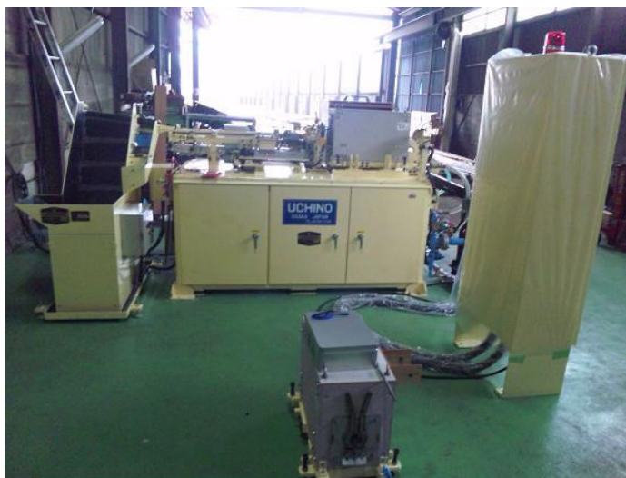
図１１ 高周波加熱装置
