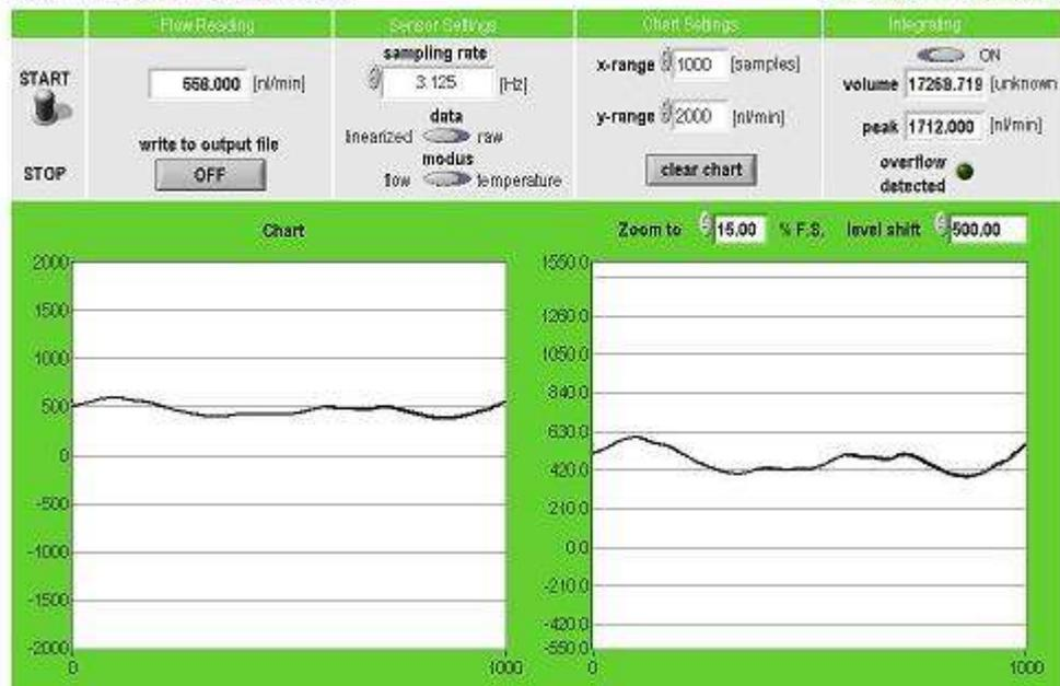
图4-10 送液速度測定結果（吐出速度 0.5 $\mu$  l /min）
