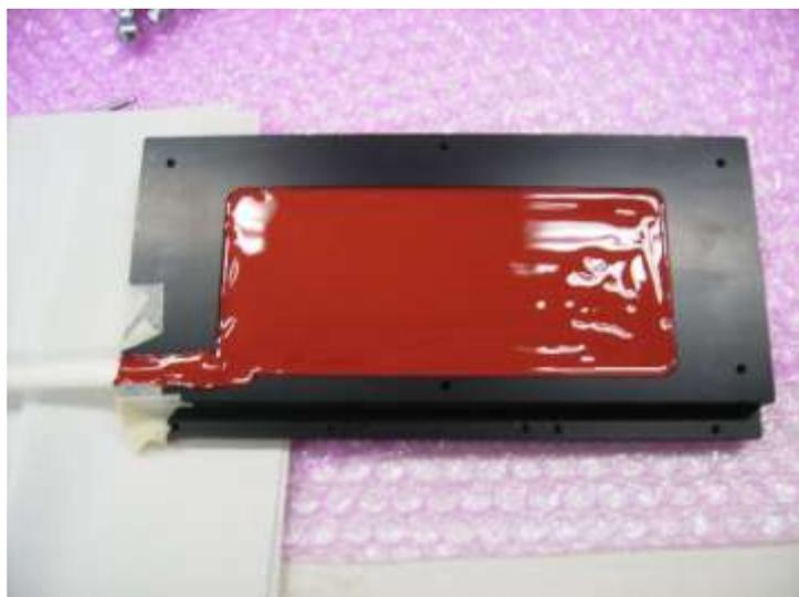
図21 電流制限抵抗の絶縁樹脂によるモールドの様子
