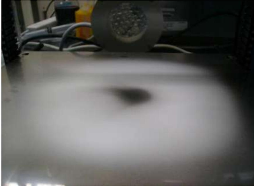
図19 スプレー距離15cmによるデポジットの様子
