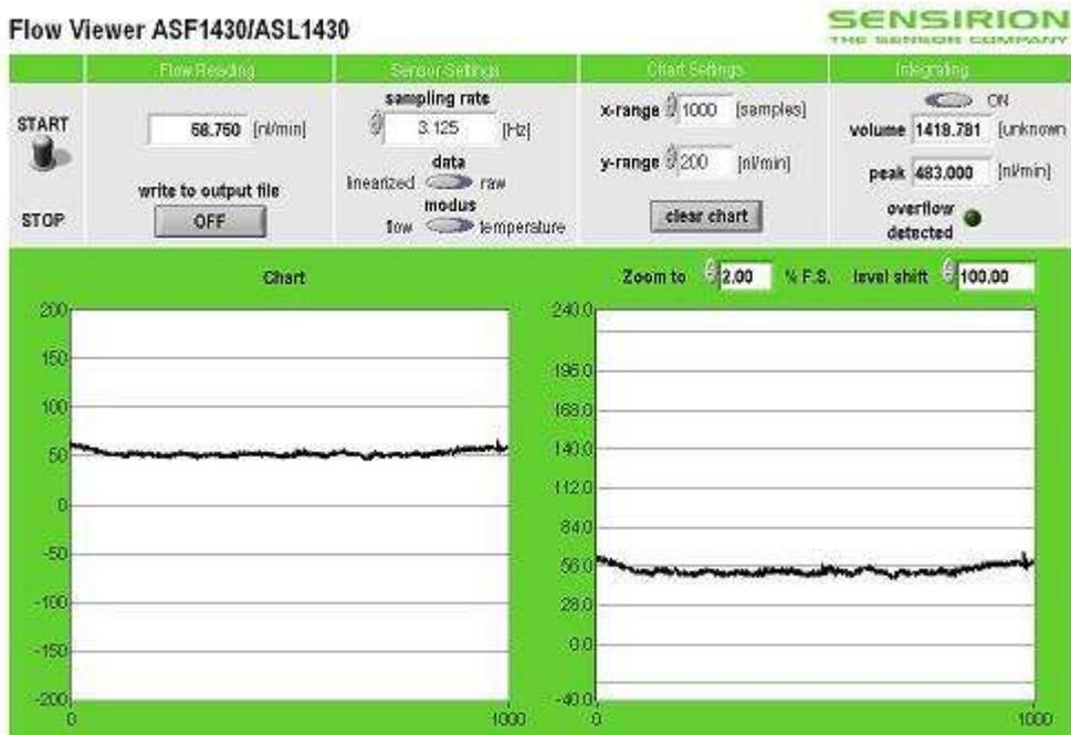
図4-11 送液速度測定結果（吐出速度 0.1 $\mu$ l /min）
