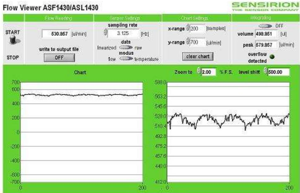
图4-3 送液速度测定结果 (吐出速度 500 $\mu$  l /min)
