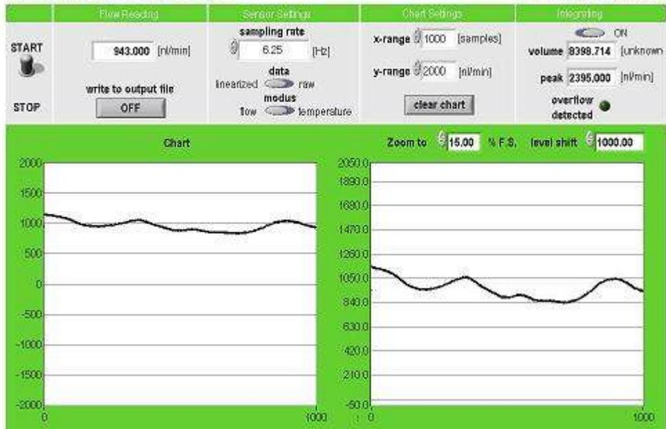
图4-9 送液速度測定結果（吐出速度 1 $\mu$  l /min）
