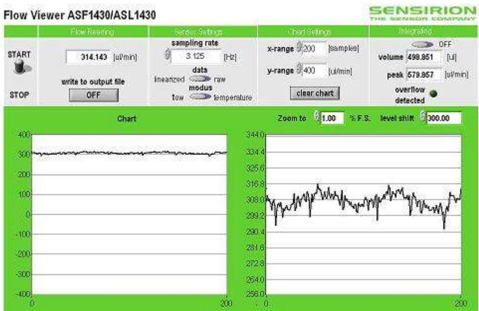
图4-4 送液速度测定结果 (吐出速度 300 $\mu$  l /min)
