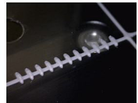
図3-2-3-2 串刃形状 (改良後)
