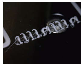
図3-2-3-1 串刃形状 (不良)
