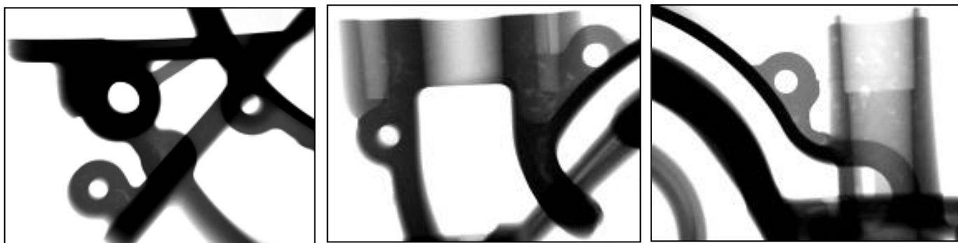
写真2-5-4 重要箇所X線装置にて内部欠陥確認
