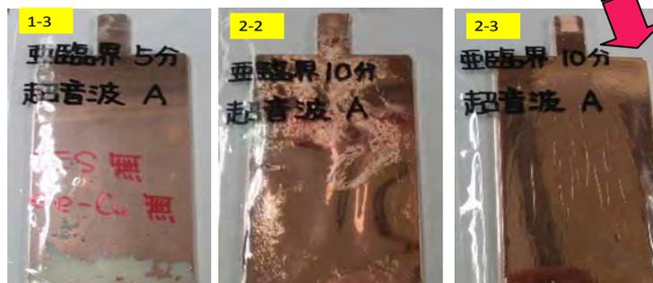
図 15 無電化銅めっき約 0.5 μm成膜での ABS 樹脂と銅めっきの密着性/全面
