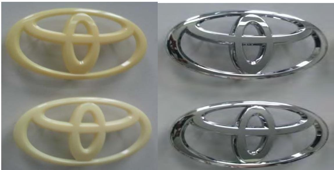
図 17 ABS 樹脂エンブレム⇒めっき前処理後⇒黒坂鍍金工業所(株)めっき処理
