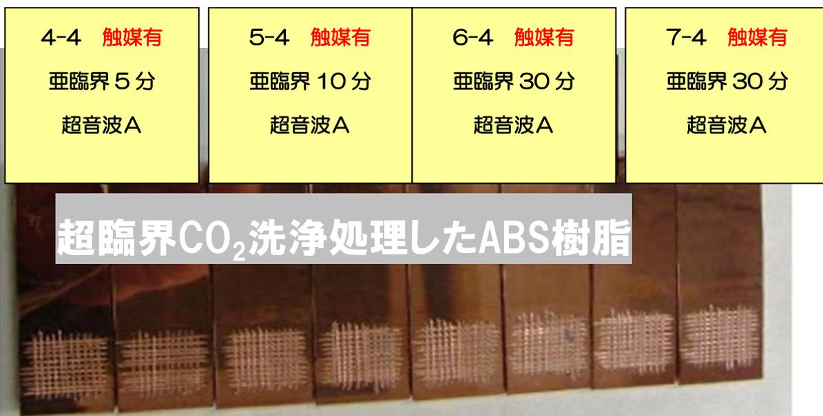
図14 無電解銅めっき約0.5 μm成膜でのABS樹脂と銅めっきの密着性/OK
