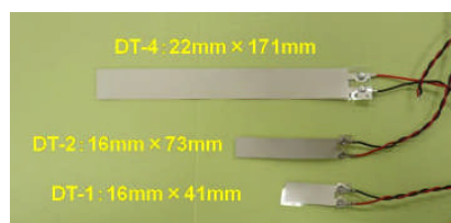
図2-1-1-3 ピエゾフィルムのサイズ比較
