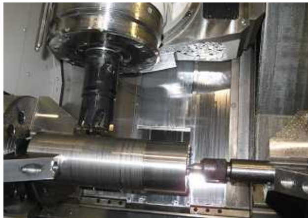
Fig.3.1.4.2 素材チャッキング（加工前状態）
