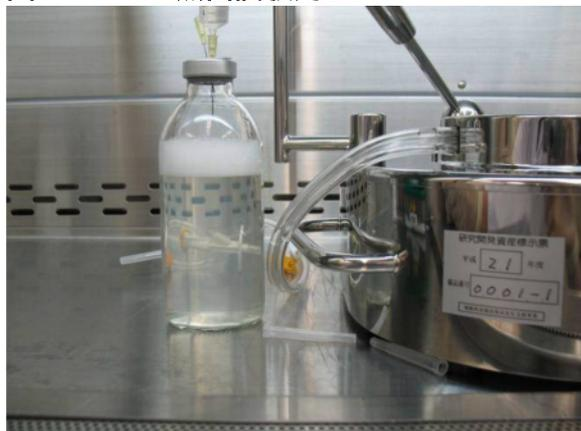
注射用水で溶解した製剤を洗浄液に添加
