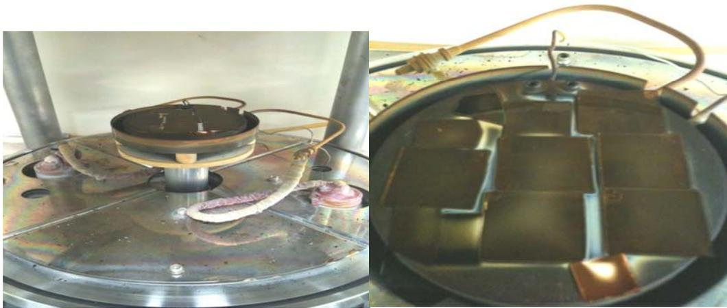
図 3-3 MW SWP CVD 装置によるカーボン堆積の様子
