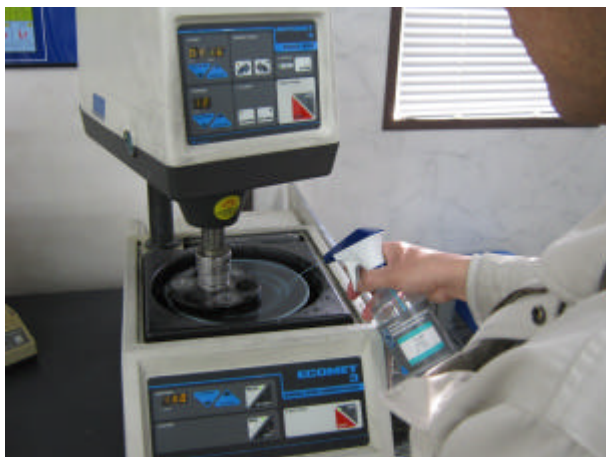
写真 1. 皮膜断面の鏡面研磨時の様子 (皮膜硬度及び気孔率の測定時)
