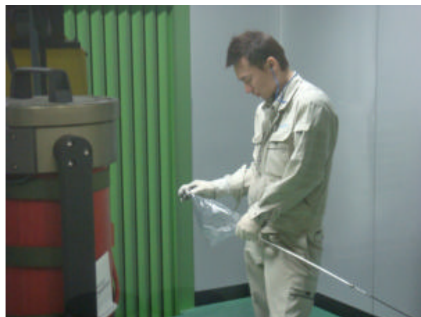
写真 2. 成膜効率測定の様子 (粉末供給量の測定時)
