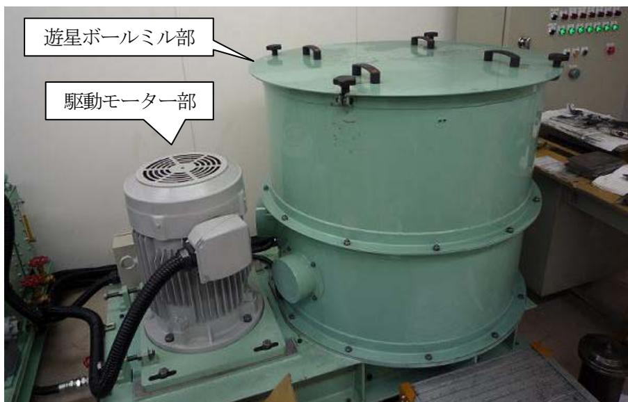
図1. バッチ式遊星ミル外観写真
