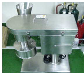
図 2-2-6 実験用小型粉碎機 (ダルトン社製)
