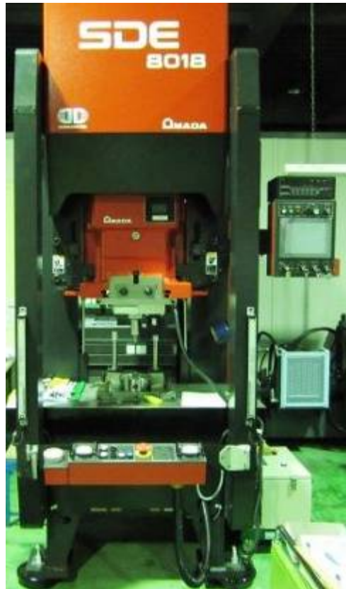
図 2-1-1 80ton サーボプレス機
