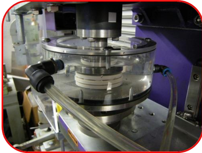
図 2.1.2.1.1.2 洗浄環境下での実験における洗浄バスの拡大写真
