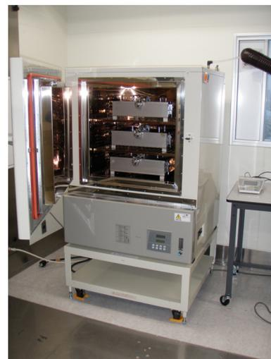
Fig3-3 粒子成長熱処理炉とセットしたコンテナボックス
