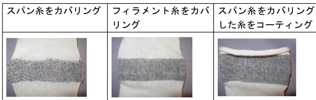
図 3-20 撚糸と併用した糸の編成試験結果
