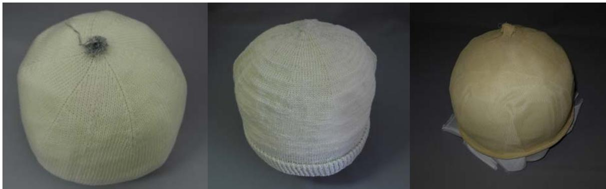
図 2-17 2針床の6枚ハギアクリル系サンプル(左)と2針床の10枚ハギ麻×PP系サンプル(中)と4針床の16枚ハギPBT系サンプル(右)
