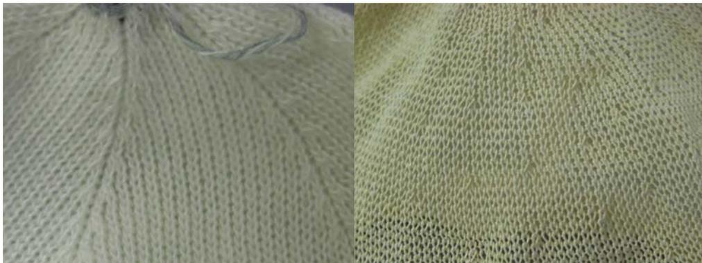
図 2-16 2針床の6枚ハギ(左)と4針床の16枚ハギ(右)の減らし目の様子
