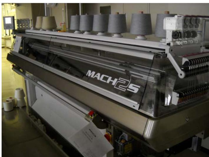
3次元形状に合わせたサンプルの編成には総針数の多いハイゲージ4針床無縫製試験編み機(島精機製作所 MACH2X 15L)が理想であると考えられるが、伸びない資材系
