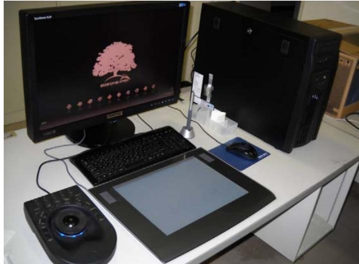
設計した編方図データを実際に編み機で編むためには、編み機の制御データ（自動制御データ）に変換する必要がある。編方図データから、編み機の制御データは島精機製作所製 SDS-ONEAPEX のニットCADシステムで行った。
