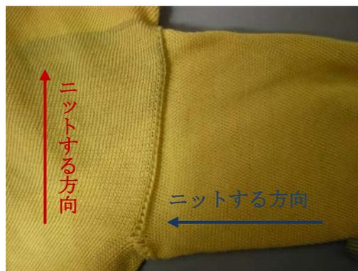
図 2-24 T字型のつなぎ部分の拡大図
