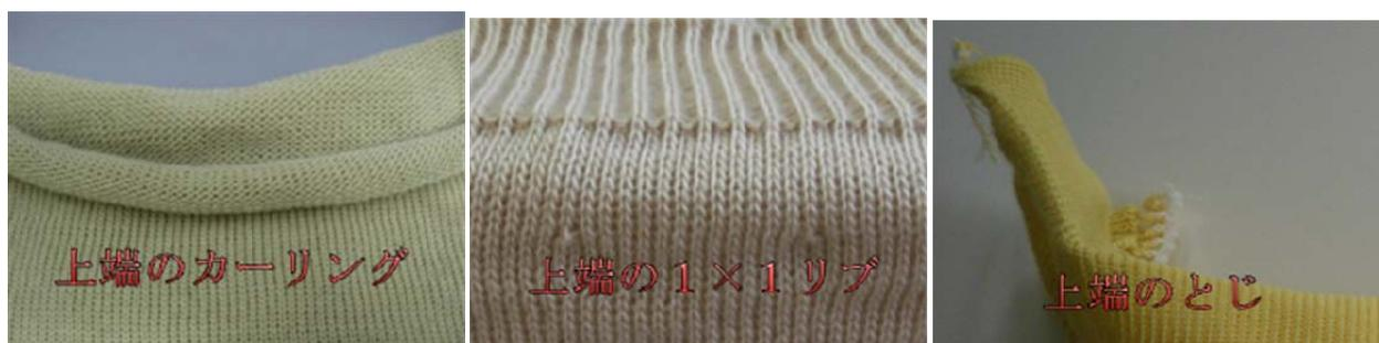
図 2-13 天竺の編地のカーリング(左)と端リブ(中)、袋とじ(右)によるカーリング防止
