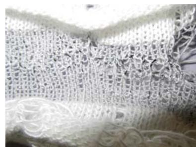
図 3-3 スパン糸カバリングの編成試験結果
