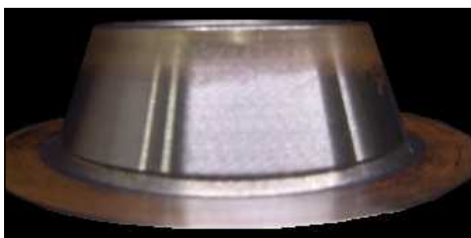
図4-2(1) b 耐久試験後の当り面確認
