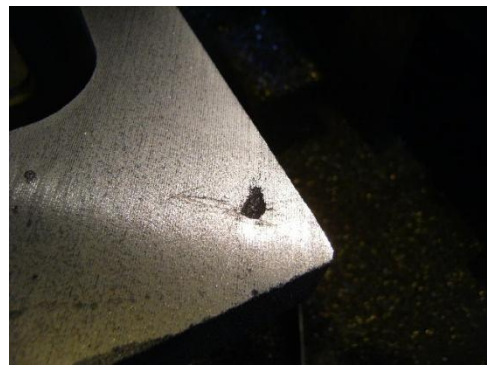
写真 27：フランジに残渣発生 10mm 加工時
