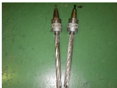
写真 1：工具 ① φ 30 ラジラス 右 先端 6 枚刃 左 先端 10 枚刃
