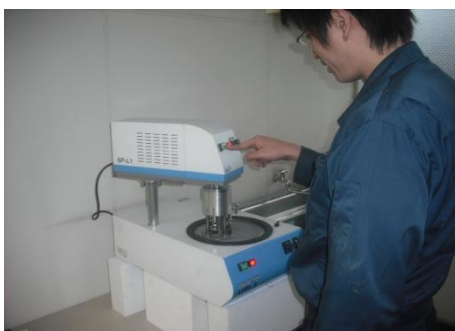
写真 19：自動試料研磨装置にて研磨作業
