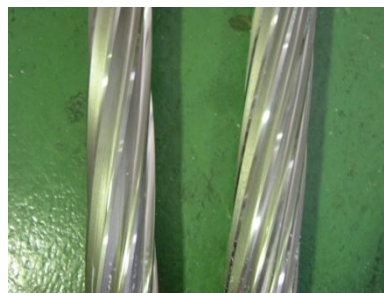
写真 1：工具 ① φ 30 ラジラス 右 先端 6 枚刃 左 先端 10 枚刃
