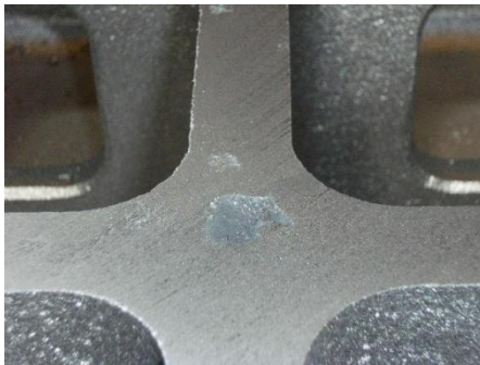
写真 27：機械加工（4mm 加工） 加工完了後は無くなっていた
