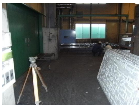
写真 10：塗型作業台の歪み除去作業
