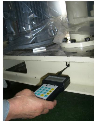
図. 音波式ベルト張力計によるベルト張力測定
