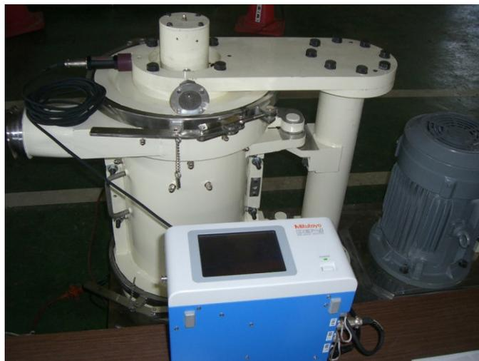
図 2-1-3. 株式会社ミットヨ製 フィールドバランサー
