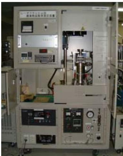
図 3.3-7 熱拡散率測定機
