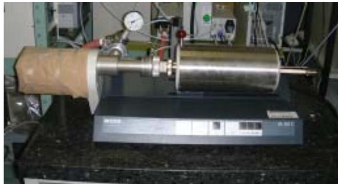
図 3.3-4 熱膨張率測定器
