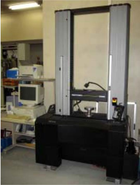
図 3.3-1 3点曲げ強度試験機
