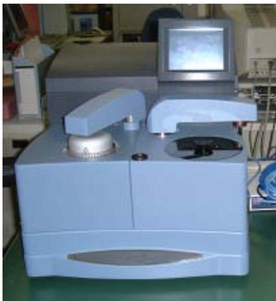
図 3.3-9 比熱容量測定機
