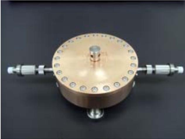
図 3.3-17 3GHz $TM_{0m0}$  モード円筒(摂動法)共振器
