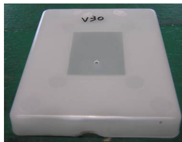
写真3-4 a) 成形体cのショートショット b) 成形体cのショートショット(約95%充填) c) 成形体cの完全充填
