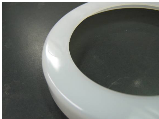
写真3-1 1 a) PLA (結晶核剤入り) 成形のウエルドライン部。加熱ユニットはオフ。
