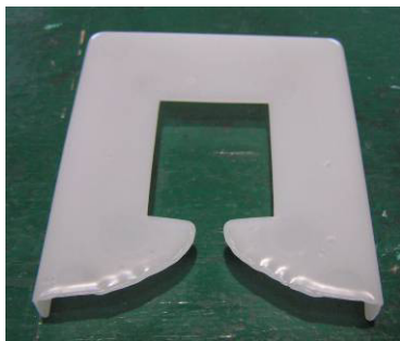
写真3-3 a) 成形体bのショートショット b) 成形体bのショートショット(約95%充填) c) 成形体bの完全充填
