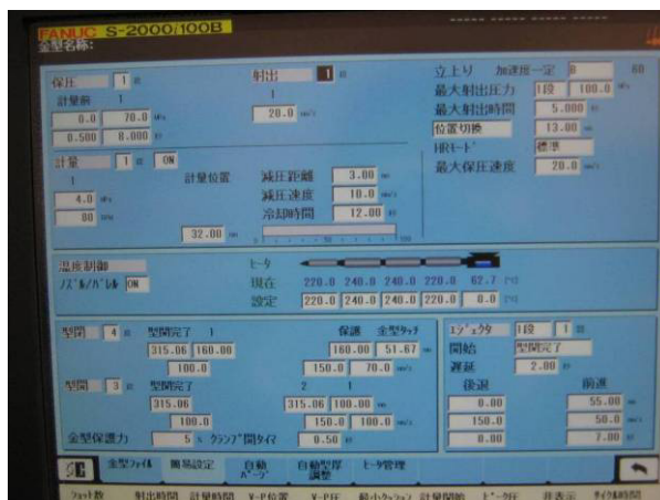
写真3-1. 射出成形機の設定 射出速度：20 mm/s、保圧：70 MPa
