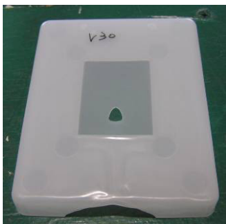
写真3-4 a) 成形体cのショートショット b) 成形体cのショートショット(約95%充填) c) 成形体cの完全充填
