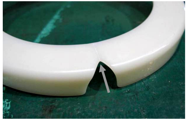
写真3-2 a) 射出成形の成形のトライにおいて、ABS樹脂を用いてショートショット（意図的に未充填の成形品）を作製しウエルド位置を確認。樹脂はゲート位置から流入・分岐し、ウエルド位置で衝突する。 b) ウエルド位置の拡大写真。再会合の際の角度が強度等に重要である。
