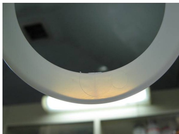
写真3-1 2 a) PLA (結晶核剤入り) 成形のウエルドライン部をすかして観察。加熱ユニットはオフ。
