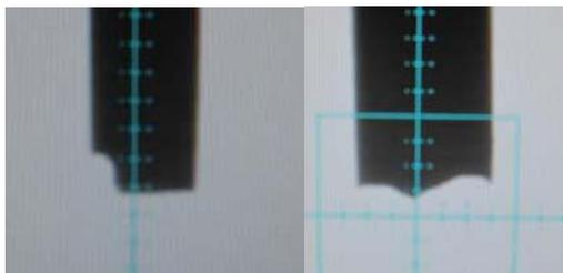
図 8-4 放電加工によるPCD工具の机上成形結果
