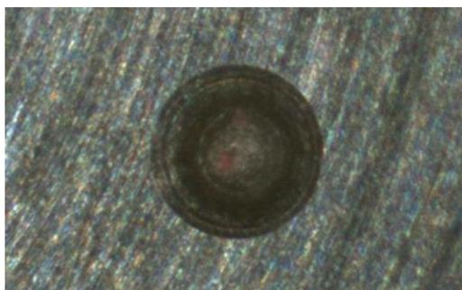
Fig.11-3 ダイヤモンドコーティングドリル( $\phi$  0.3)の加工結果
