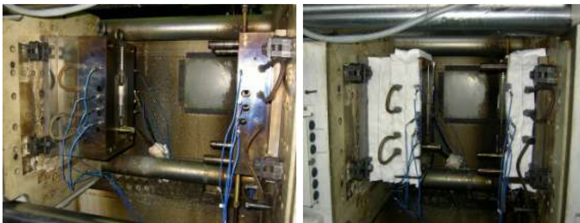
図2. 2. 3-2. 断熱材装着前後の金型写真 (左：断熱材装着前、右：断熱材装着後)
