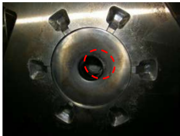
図2. 4. 3－1. 金型溶損発生時の金型写真（赤丸部）
