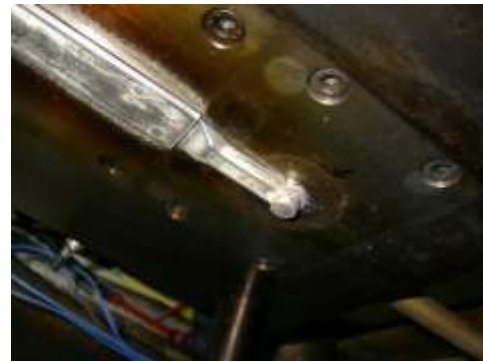
図2. 1. 2-2 固定側に張り付いた 金型写真
