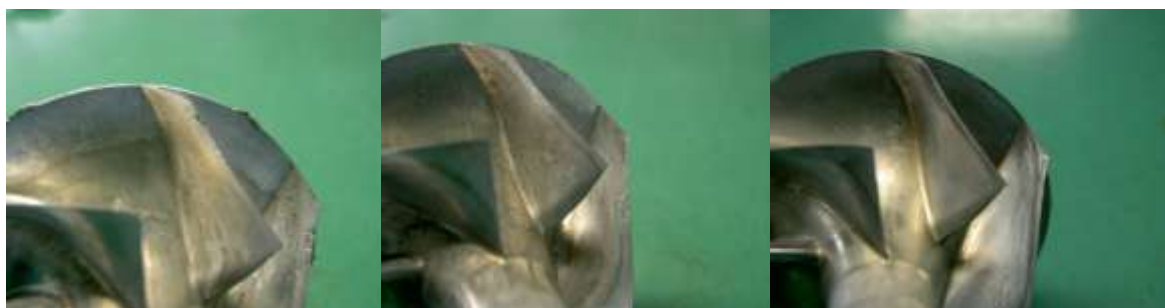
図2. 4. 2－4. 金型温度違いでの羽形状比較の一例 (上段：長翼、下段：短翼)
